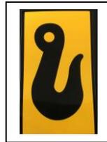
La fixation avec une élingue doit s'effectuer ici si le rouleau est soulevé avec une grue ou un chariot élévateur.
