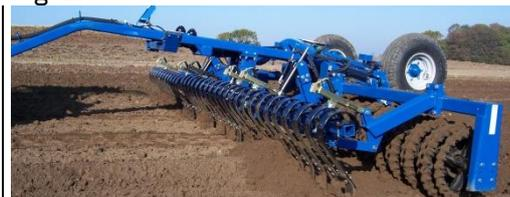
Le Crackerboard n'a **pas** pour but de servir de lame de remblayage, mais plutôt de labourer légèrement le sol. Étant donné que chaque dent bouge individuellement et fournit ainsi une résistance locale, le Crackerboard est facile à conduire.
