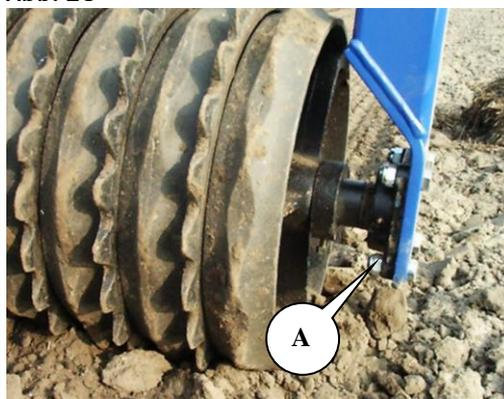
Sofern kein Kran zur Verfügung steht, kann die Gewichtsverteilung der POWERROLL evtl. leicht aktiviert und in eine Position gebracht werden, in der sich die Bolzen lösen und abmontieren lassen.
