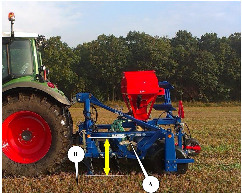
Eine unkorrekte Höhe der Kupplung führt zu einer ungleichmäßigen Bearbeitung des Felds, da die Walze evtl. nach vorn neigt und der Striegel dadurch in der ersten Reihe zu hart greift.
