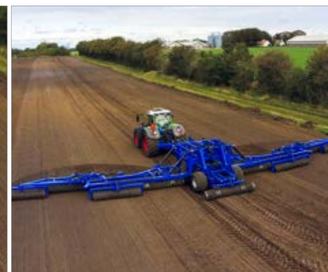
4. Når tromlesektionerne er i arbejdspositionen, de 2 hydrauliske vægtfordelingssystemer er i korrekt arbejdsstryk og i flydestilling, er hjulene automatisk hævet fri af jorden.
