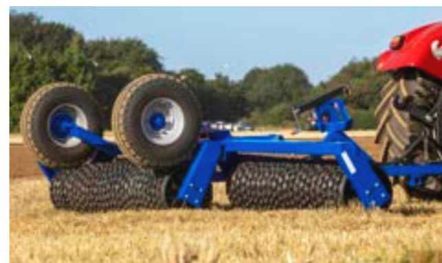
3. Tromlesektionerne sænkes til arbejdspositionen, og hjulene hæves automatisk fri.
