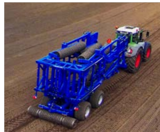
1. Sektionerne løftes ud af transportsikringen.
